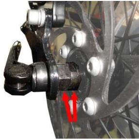
Si vous souhaitez démonter une roue avec serrage rapide, il faut desserrer et extraire la roue.
