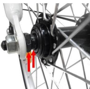
Retirer la protection plastique qui protège l'extrémité inférieure de la fourche et emboîter la roue. Vous devez vous assurer que la roue soit parfaitement emboîtée dans la fourche en exerçant une légère pression sur le guidon vers le bas. Serrer l'écrou extérieur de l'axe avec une clé de 15 ou avec une clé anglaise, et en même temps, maintenir l'écrou intérieur avec une clé de 17. Répéter l'opération des deux côtés.
