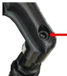
Ne pas dépasser la marque d'insertion minimum de la potence. Elle doit être occultée par le tube du cadre.
