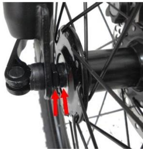
Passer la clé de serrage rapide à l'intérieur de l'axe, en le mettant du côté opposé au disque, et visser l'écrou (du côté du disque) en ne faisant que quelques tours, suffisamment pour ne pas qu'il tombe. Laisser la clé de serrage rapide ouverte. Elle doit être positionnée du côté opposé au disque du frein.
