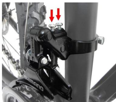
Positionner la chaîne et les manettes sur le petit plateau et le grand pignon. Tourner la vis de régulation des limites intérieure (L) de telle sorte que la chaîne se rapproche au maximum du dérailleur, mais sans qu'elle le touche.
