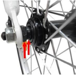
Pour monter la roue, la placer dans la bonne position et effectuer l'opération inverse: serrer les écrous extérieurs (de chaque côté), pendant que vous maintenez les écrous intérieurs.
