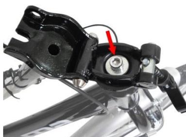
Soulever le guidon et l'aligner avec la roue. Plier le guidon vers le bas et visser. Soulever de nouveau le guidon et s'assurer qu'il est parfaitement aligné. Dans le cas contraire, réitérer l'opération.
